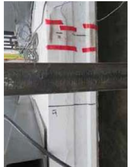
Şekil 5. ÖBD ve yapısal kaplama betonu arasında görel kayma ve açılma hareketlerini kaydetmek üzere kullanılan ölçüm düzeni (sol resim) ve açıklık kesitine yapıştırılmış şekildeğıştirme ölçerler (sağ resim)
