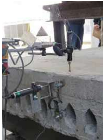
Şekil 5. ÖBD ve yapısal kaplama betonu arasında görel kayma ve açılma hareketlerini kaydetmek üzere kullanılan ölçüm düzeni (sol resim) ve açıklık kesitine yapıştırılmış şekildeğıştirme ölçerler (sağ resim)
