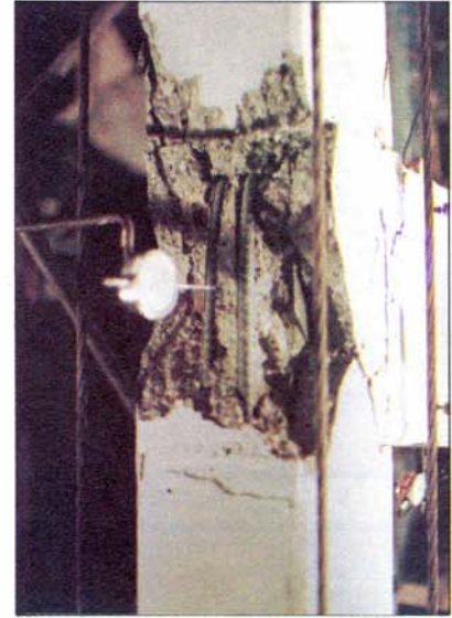
Resim 3: Öndökümlü Numunede Deney Sonunda Kabaran Kabuk Söküldükten Sonra Kolonun Dış Yüzündeki Görünüm
