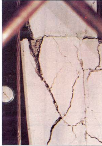
Resim 2: Öndökümlü Numunede Yedinci Yükleme Devri Sonunda Birleşim Bölgesindeki Kabuk Kabarması ve Çatlaklar
