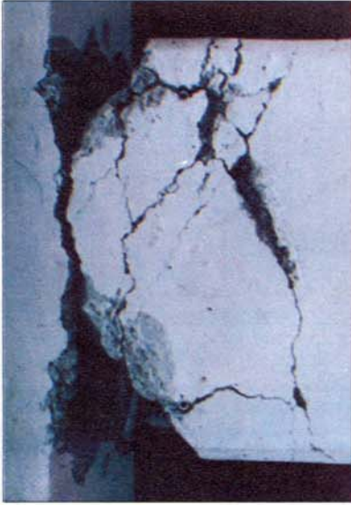
Resim 1: Monolitik Numunede Deney Sonunda Plastik Mafsalsal Bölgesi
