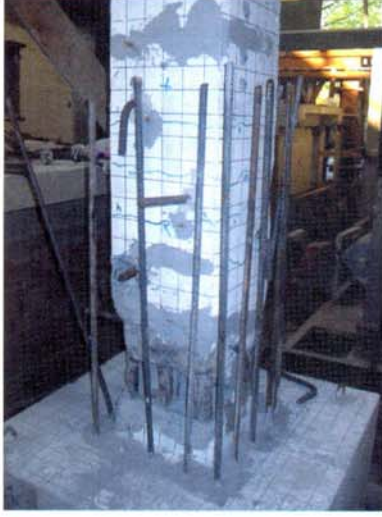
Şekil 5. Güçlendirme aşamasındaki SR30_14 numunesi
