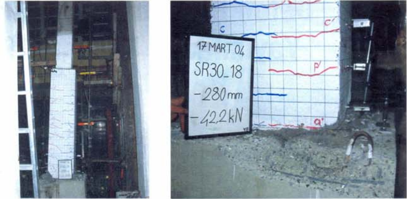
Şekil 7 SR30_18 numunesine ait hasar fotoğrafları
