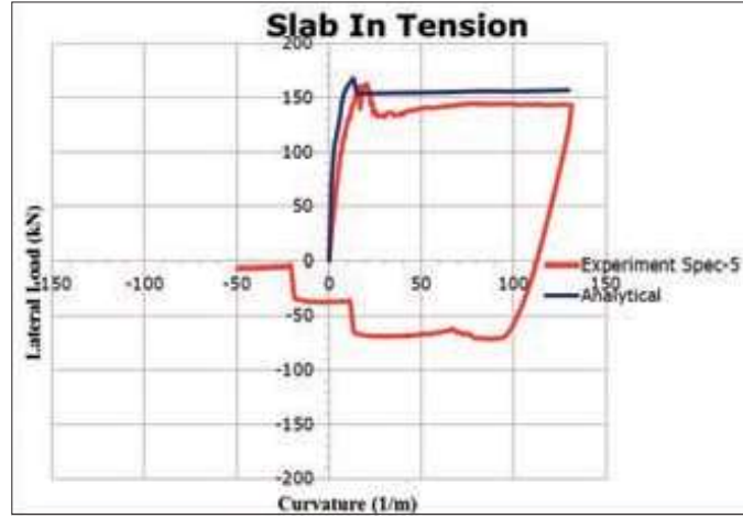
Şekil 26. Döşemenin çekmede olduğu durum için yatay yük-yerdeğiştirme ilişkisi
