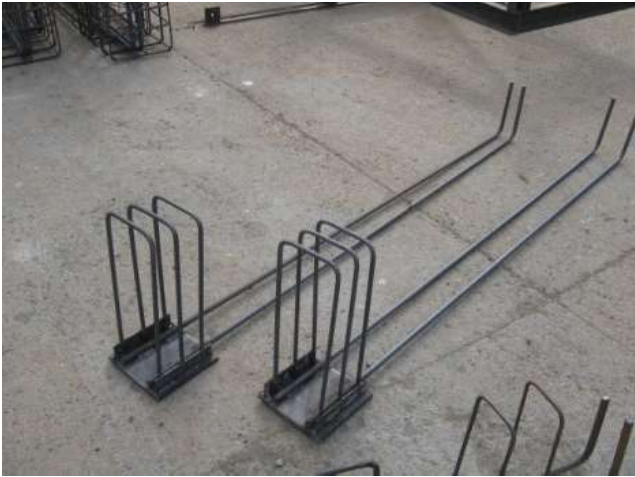
Şekil 14. Endüstri tipi birleşimde yapılan iyileştirmeler
