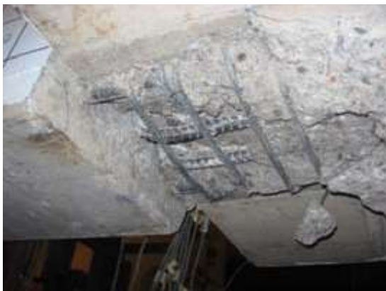
Şekil 19. İyileştirilmiş Konut tipi numunelerde hasar durumu
